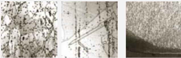
CuCrZr antes y después del recocido a 900°
