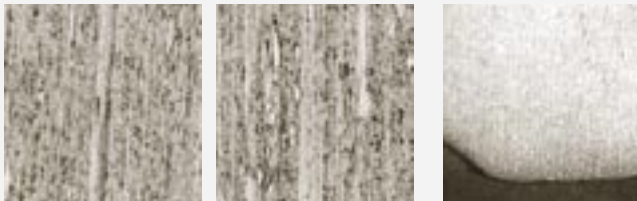
Nitrode antes y después del recocido a 900°
