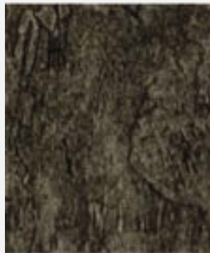
Estructura de grano fino de CuCrZr de Luvata
