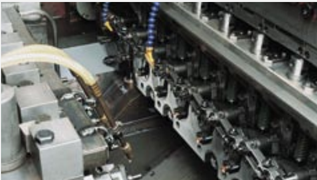
Cabeceo en frío de electrodos
