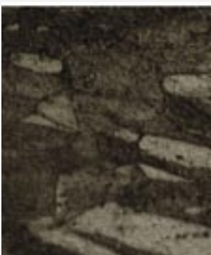
Estructura convencional de grano CuCrZr
